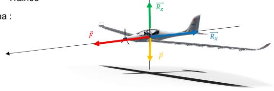
La force de propulsion est choisie horizontale (compatible avec le vol à altitude constante dans la suite du problème)
